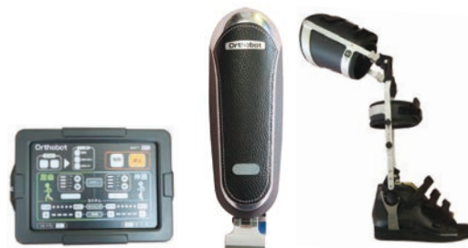
液晶モニター、本体ユニット、 長下肢装具をセットで使用します
